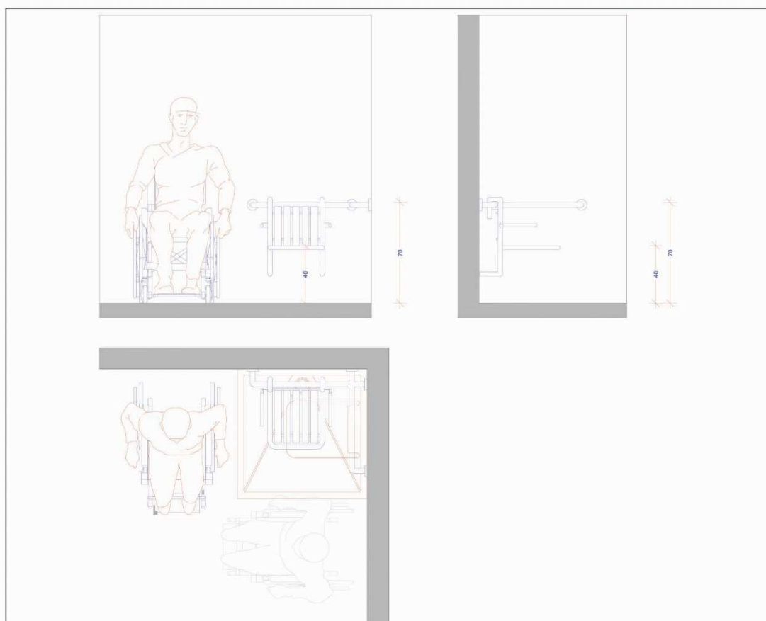
FIGURA 9 - Nello schema esemplificativo, la doccia di tipo a pavimento è dotata di seggiolino la cui seduta è, per dimensioni, uguale a quella della tazza w.c. Per quanto riguarda i maniglioni e il seggiolino è conveniente utilizzare un maniglione ad angolo retto con seggiolino da appendere allo stesso: in tal modo spostando il seggiolino si avrà la bilateralità di accostamento laterale
